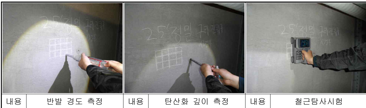
【사진 1.5】 구리인출 전력구 재료시험 전경
